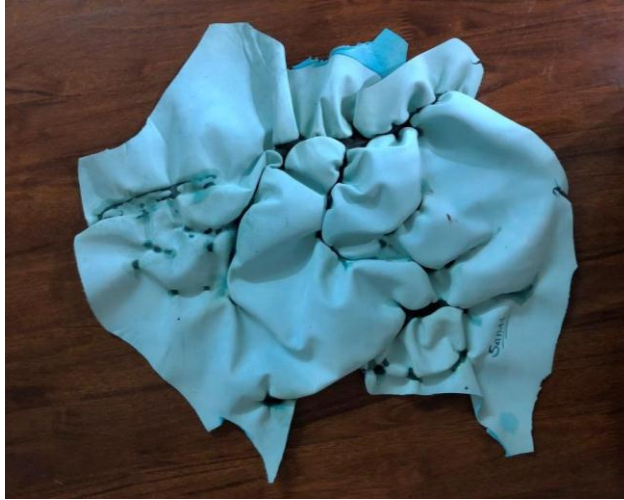
شكل ( ٢٢ ) تأثير حمض الهيدروكلوريك HCL مع رقائق القصدير على الجلد الطبيعي . تصوير الباحثة
