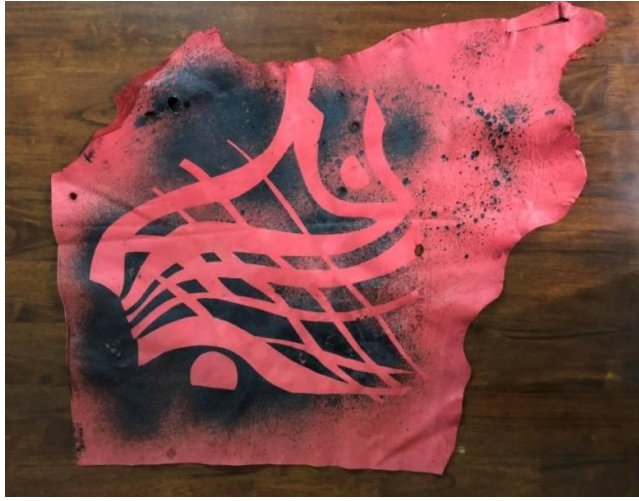
شكل ( ١٨ ) تأثير حمض الكبريتيك H_2SO_4 على الجلد الطبيعي .
