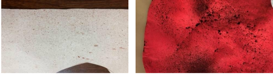
شكل ( ١٢ ) تأثير حمض الكبريتيك H_2SO_4 على الجلد الطبيعي بطريقة البخ ( الاسبري )
