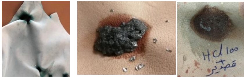
شكل ( ٥ أ ، ب ، ج ) تأثير حمض الهيدروكلوريك HCL مع ضافة رقائق القصدير على الجلود
