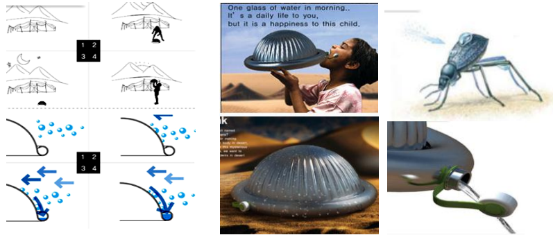
شكل ( ٢٦ ) فكرة بسيطة للحصول علي مياه عذبة بطريقة ذاتية مثل الخنفساء التي تعيش في الصحراء عن طريق تكثيف مياه الندى في الصباح والأحتفاظ بها داخل القارورة. المصدر: http://www.yankodesign.com/2010/07/05/beetle-juice-inspired
