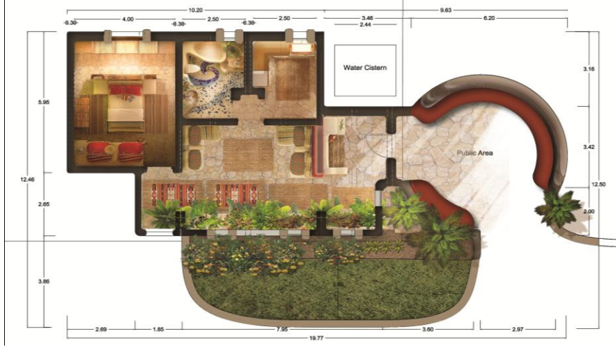
شكل (35) يوضح مسقط افقي للتصميم المقترح للوحدة السكنية – و الحديقة الداخلية و الخارجية. من تصميم الباحث
