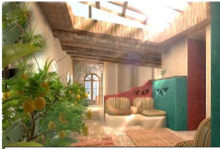
شكل (٣٣) تصميم الوحدة المقترحة وفتحات في السقف لغمر المكان بالأضاءة الطبيعية و خروج الهواء الساخن من اعلي. تصميم الباحث
