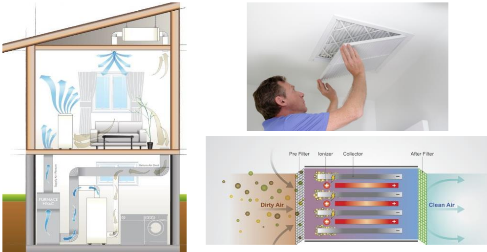
شكل رقم (١٤) آليات ترشيح الهواء المعاد تدويره في العملة الداخلية
